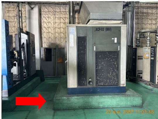
รูปถ่ายที่ 3.2-3 : เครื่องจักรติดตั้งบนฐานซับเสียงเพื่อลดเสียงดัง
